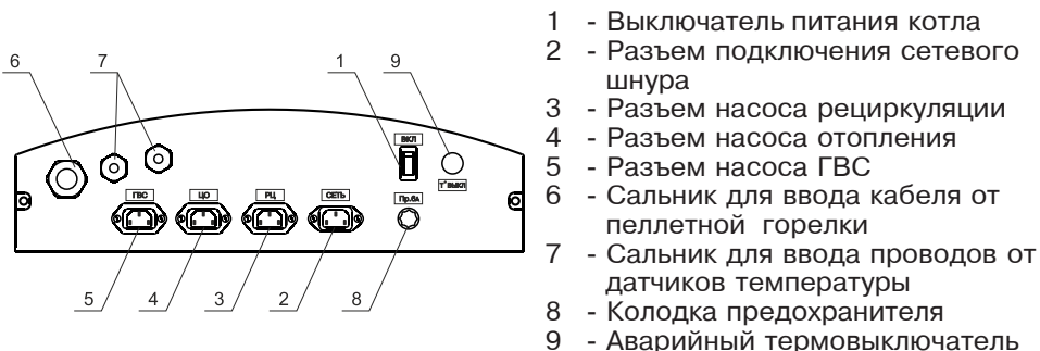
Рис.6 Расположение органов управления на задней панели пульта
