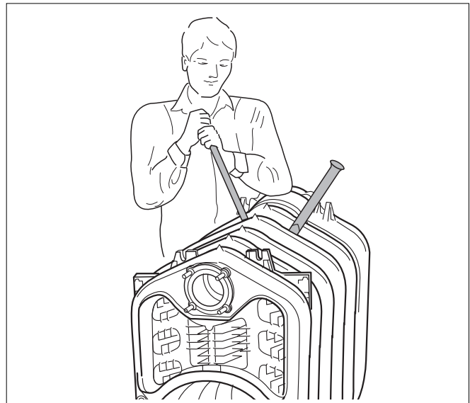
Рис. 26 Разъединение секций котла
