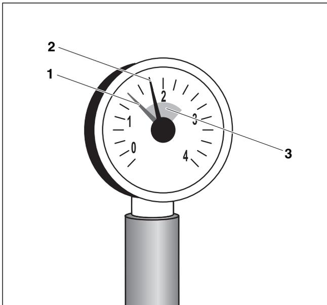
Рис. 43 Манометр для закрытых отопительных установок
