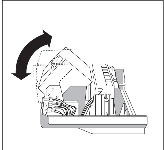
Рис. 16 Наклон панели индикации
