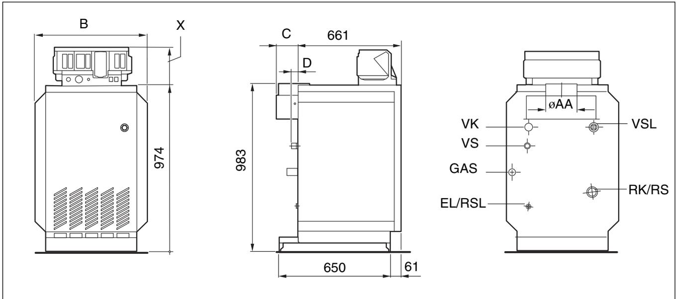
Рис. 2 Специальный газовый отопительный котел Logano G234 WS. Вид спереди, сбоку и сзади.
