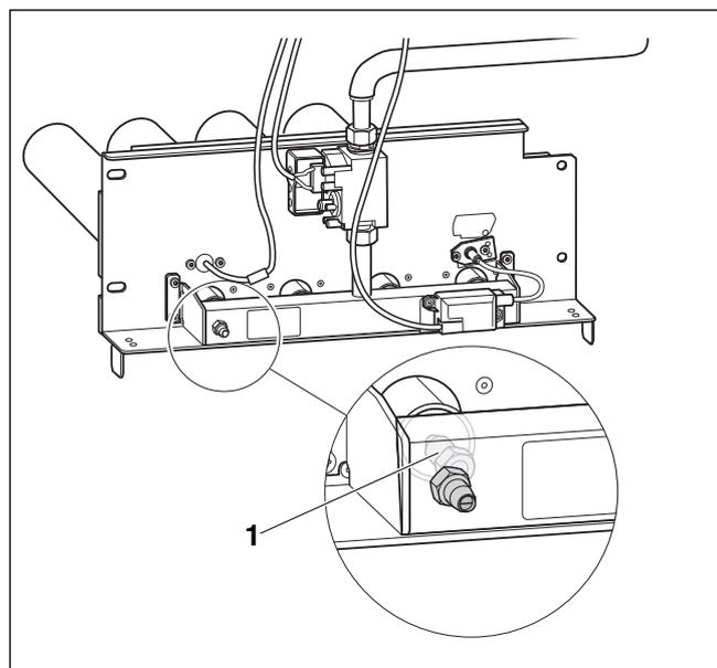
Рис. 23 Контроль форсунок основного газа
