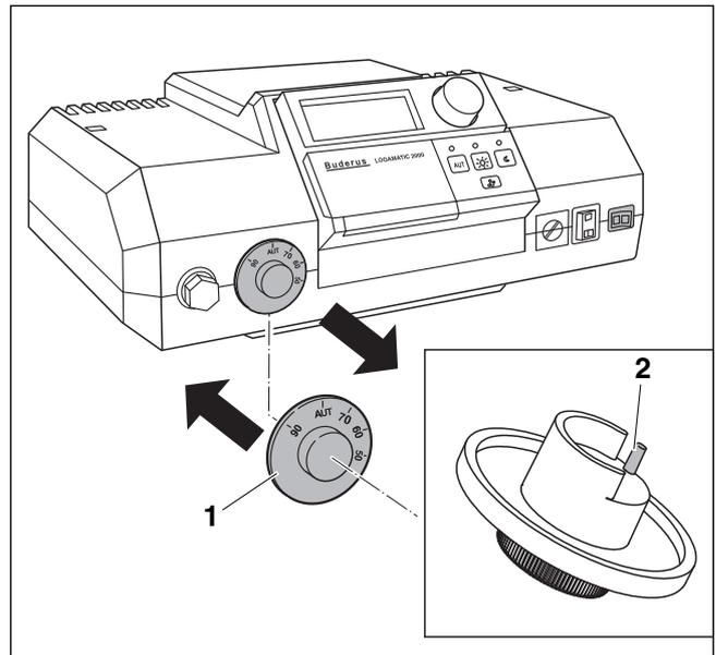
Рис. 17 Замена ручки настройки регулятора температуры котловой воды
