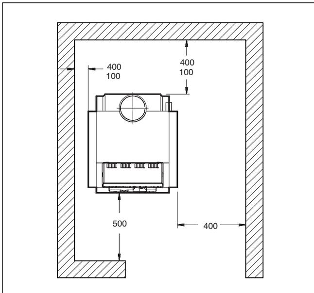
Рис. 3 Помещение для установки котла (расположение слева).
