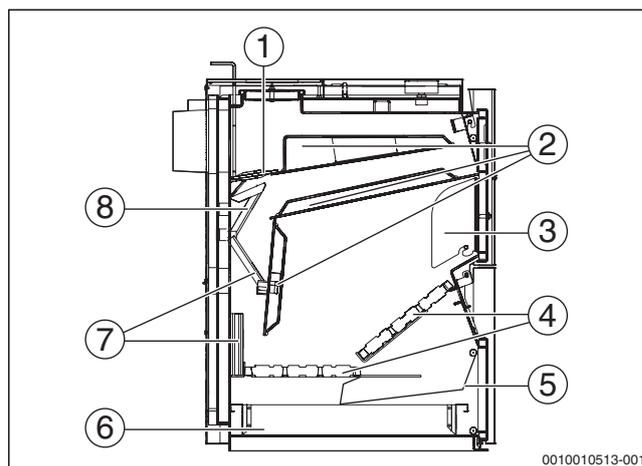
Рис. 2 Внутреннее устройство котла (показан в разрезе)
