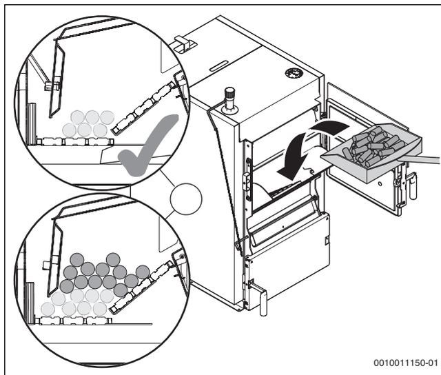
Рис. 10 Загрузка топлива на угли в котле
