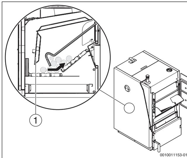
Рис. 9 Ворошите угли и очищайте пространство под пластиной
