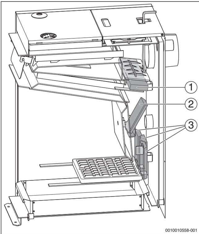
Рис. 19 Положение камней в топочной камере (вид сбоку)
