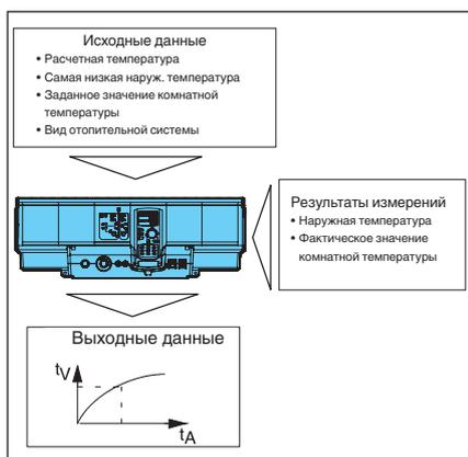
Благодаря функции адаптации и самооптимизации модульная система управления Logamatic 4000 в соединении с дистанционным управлением в контрольном помещении приводит отопительную кривую в соответствие с теплотехнической характеристикой здания.
