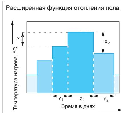
заданному моменту времени уже должна быть достигнута комнатная температура, устанавливаемая для дневного режима. Модульная система управления Logamatic 4000 рассчитывает время, когда должно включиться отопление, с учетом комнатной и наружной температуры. В результате достигаются комфортные условия и экономичность.
